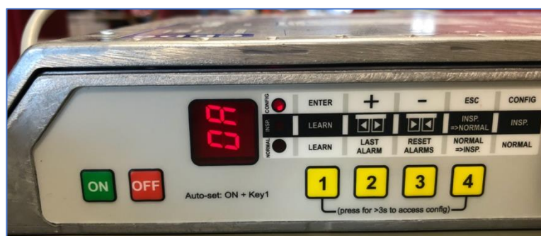
Fig. 1 – Impostazione parametro P-0A tramite pannello frontale
