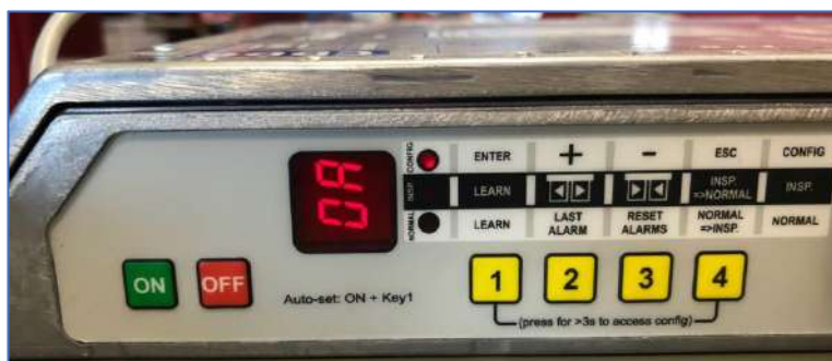
Fig. 1 – Impostazione parametro P-0A tramite pannello frontale
